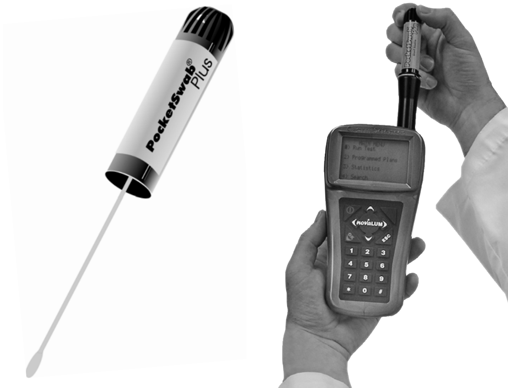
Figura 2.3 Sistema per l'esecuzione di test rapidi mediante la misurazione dell'ATP quale indicatore delle condizioni igieniche di superfici e acque di risciacquo. A sinistra tampone per il prelievo; a destra bioluminometro. (Per gentile concessione di Ecolab S.r.l. - Food & Beverage, Italia)
