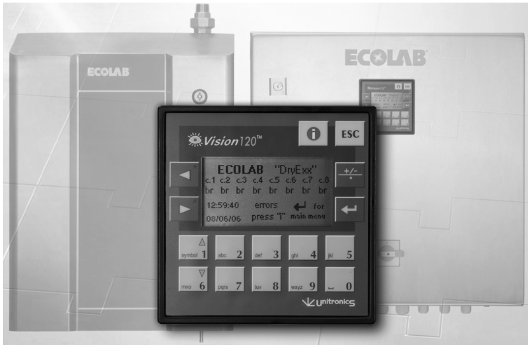
Figura 10.13 Dettaglio dell'unità di controllo del sistema DryExx per la lubrificazione a secco senza spazzole di nastri trasportatori per bottiglie, lattine o brick. (Per gentile concessione di Ecolab S.r.l. - Food & Beverage, Italia)
