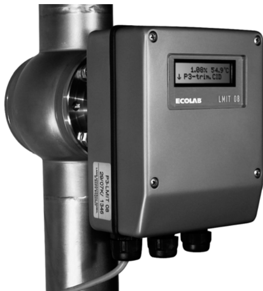
Figura 10.10 Sonda di controllo per la misurazione della conducibilità e della temperatura delle soluzioni sanificanti in sistemi CIP. È possibile registrare i dati e trasmetterli ad altre utenze. Tramite la conducibilità, viene controllata e tarata la concentrazione d'uso del sanificante. (Per gentile concessione di Ecolab S.r.l. - Food & Beverage, Italia)
