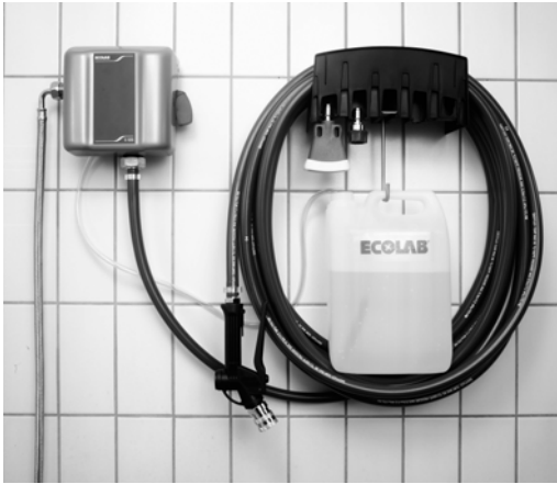
Figura 10.12 Unità di schiumatura per piccole e medie applicazioni, alimentata da acqua di rete, utile per la formazione di un film di schiuma sanificante. (Per gentile concessione di Ecolab S.r.l. - Food & Beverage, Italia)
