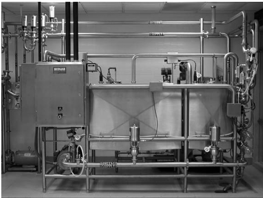
Figura 10.7 Unità CIP a perdere, con recupero parziale della soluzione, facente parte di un sistema dotato di serbatoio di alimentazione dell'acqua e unità di ricircolo CIP. (Per gentile concessione di Ecolab Inc., St. Paul, Minnesota)
