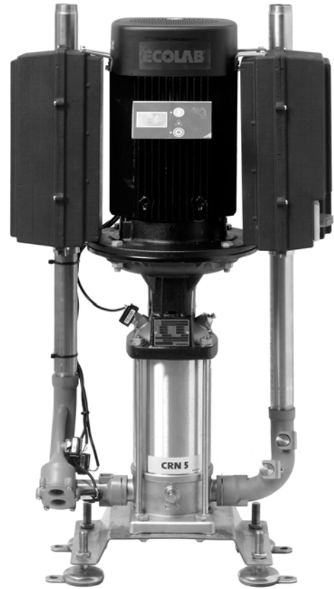
Figura 10.2 Booster con supporto a pavimento, cuore del sistema a media pressione per la pressurizzazione dell'acqua nei sistemi di sanificazione a schiuma. (Per gentile concessione di Ecolab S.r.l. - Food & Beverage, Italia)
