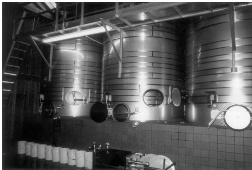
Figura 19.1 Vasi vinari in acciaio per la fermentazione dei vini rossi. (Per gentile concessione di Bruce Zoecklein, Virginia Polytechnic Institute & State University, Blacksburg, Virginia)
