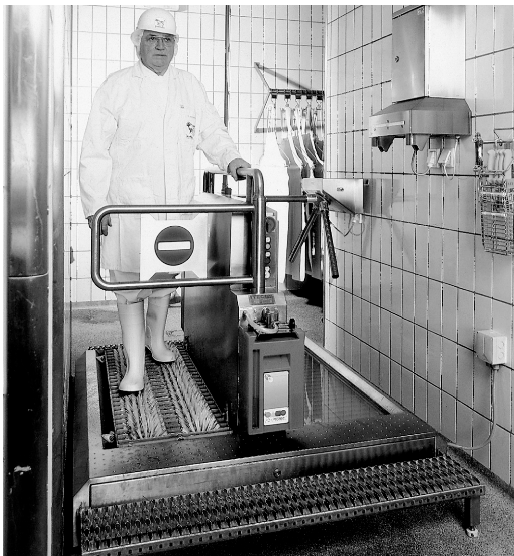
Figura 13.1 Sistema lavastivali impiegato per il controllo della contaminazione crociata agli accessi alle aree di produzione. (Per gentile concessione di Ecolab S.r.l. - Food & Beverage, Italia)
