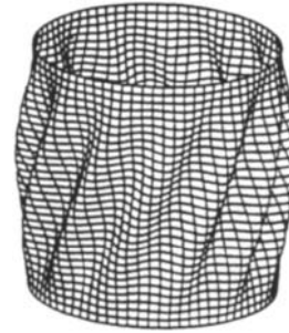
Fig. 4 : Buckling mode for torsion
