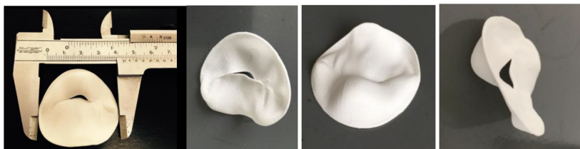
Figure 6. A–D. 3D printed model of mitral valve prolapse from 3D ultrasound (3D US)—printed in poliamide—(EOS P110)—Instituto Nacional de Tecnologia—Laboratório de Modelos Tridimensionais—Ministério da Ciência, Tecnologia e Inovação.
