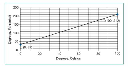
Figure 1.1 Fahrenheit Versus Celsius Temperatures
