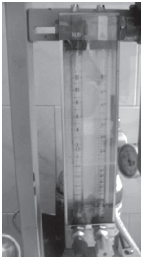
Fig. 1.13: Flow metre (Rotameter)
