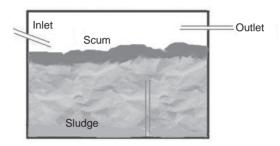
Figure 5.19. A septic tank<sup>229</sup>
