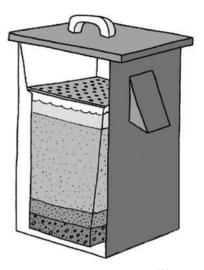
Figure 5.6. A biosand filter<sup>196</sup>
