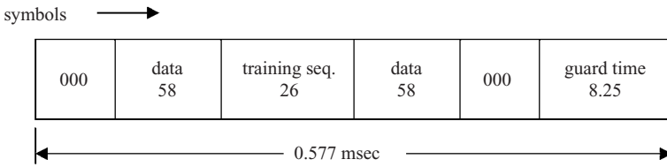
Figure 10.18 Time-slot format, EDGE
