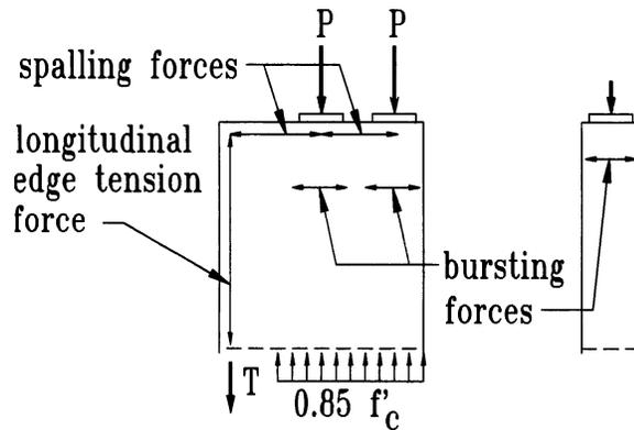
Figure C5.10.9.3.2-3—Edge Tension Forces
