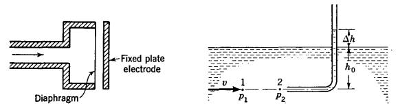
Fig. 9.4. Capacitance gage.
