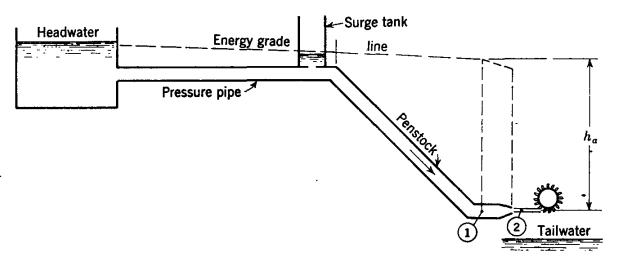
Fig. 8.10. Impulse turbine system.
