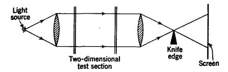
Fig. 9.13. Schlieren system.
