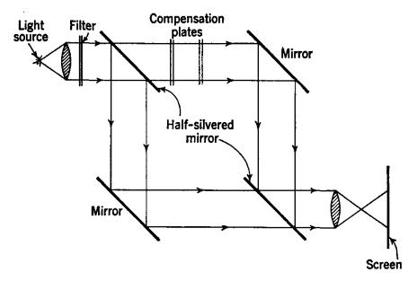
Fig. 9.16. Mach-Zehnder interferometer system.
