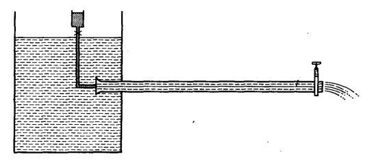
Fig. 5.12. Reynolds apparatus.
