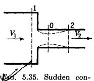
**E**6. 5.35. Sudden con traction in a pipeline.
