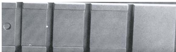
**Fig. 31.11** Phantom di alluminio che simula le vertebre D12-L5, utilizzato mensilmente per la precisione a lungo termine (Lunar GE)
