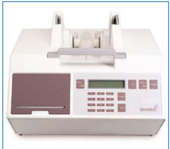
Fig. 42.2 Apparecchio QUS Sahara (Hologic Inc., Bedford, MA) applicato allo studio del calcagno
