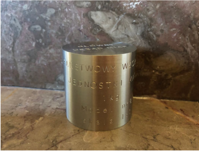
Fig. 3.1 Model of weight standard (made by Główny Urząd Miar in Warsaw, Polish NMI)
