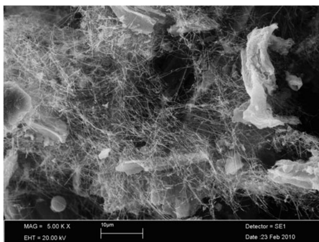
Fig. 29.9 SEM picture of SiC whiskers
