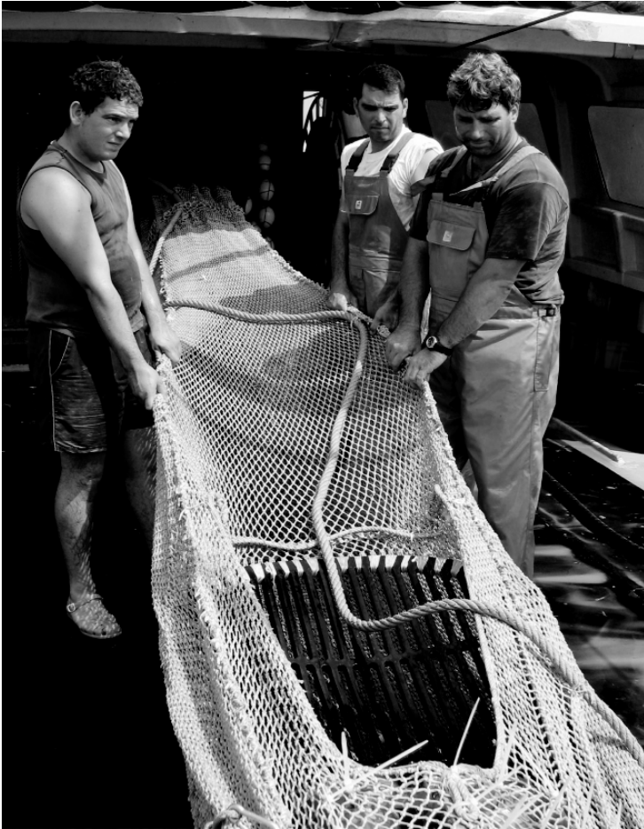
Fig. 3.4. A flexible sorting grid
