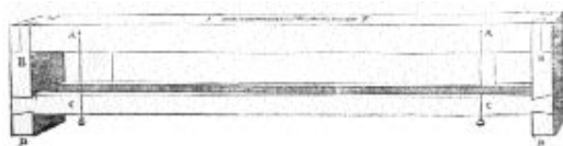
FIGS. 2 & 3 Chorobate and water scale, from Claude Perrault, Abrégé des dix livres d'architecture de Vitruve , 1674
