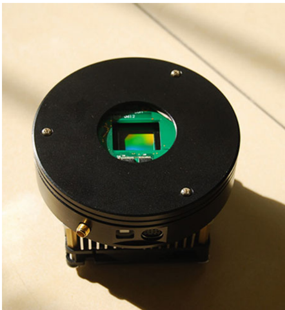
Fig. 10.7 QHY9 Monochrome CCD 8.3Mp.
