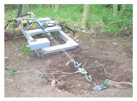
Figure 5-7. Root pull out apparatus (Photo: J.E. Norris).
