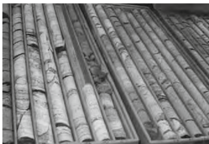
Fig. 2.17 Carotaggi effettuati dal servizio geologico norvegese per valutare la qualità della roccia in zone di frana. Una frana potrebbe cadere nei fiordi e generare una pericolosissima onda di tsunami (FVB)
