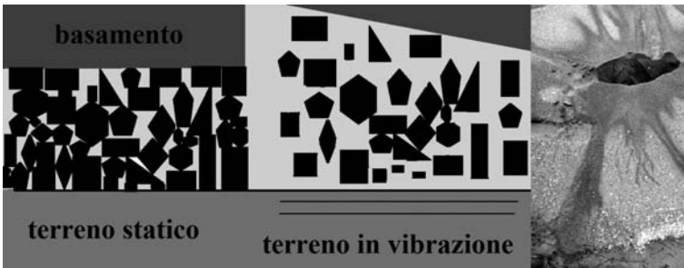
Fig. 2.13 In un suolo le particelle solide sono unite a formare una matrice resistente (a sinistra). Tuttavia, una scossa sismica (nel centro) può provocare il temporaneo distacco dei granuli e l'aumento di pressione del fluido negli interstizi. Il terreno perde così di resistenza e si liquefa; il basamento degli edifici può ribaltarsi. A destra: le argille e le sabbie ricche di acqua liquefatte dalle scosse sismiche (in questo caso il terremoto di Loma Prieta del 1989) possono venire in superficie attraverso degli strani vulcanetti. I terreni liquefatti giacciono in profondità e sono collegati al vulcanetto da un tubo. In questo esempio le sabbie sono ricche di fossili quaternari. Il vulcanetto ha un diametro alla base di circa due metri. Bay bridge (California). Foto di J.C. Tinsley di dominio pubblico, cortesia USGS americano
