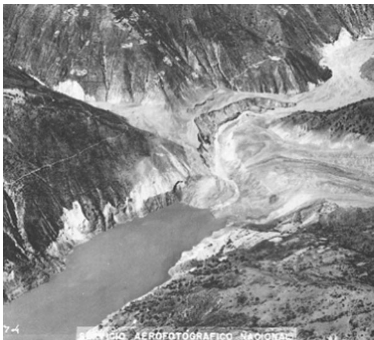
Fig. 3.13 Aerial view of the Mayunmarca landslide dam (from the Servicio Aerofotográfico Nacional del Perú)
