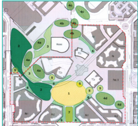
Fig. 12.6 Schizzo preliminare di indirizzo progettuale del parco Citylife: 1 = grande parterre centrale; 2 = sistema dei boschi urbani; 3 = radure di collegamento; 4 = giardini tematici; 5 = macchie arborate (e stepping stone ); 6 = macchie arborate di tamponamento; 7 = prospettiva Buonarroti-G. Cesare
