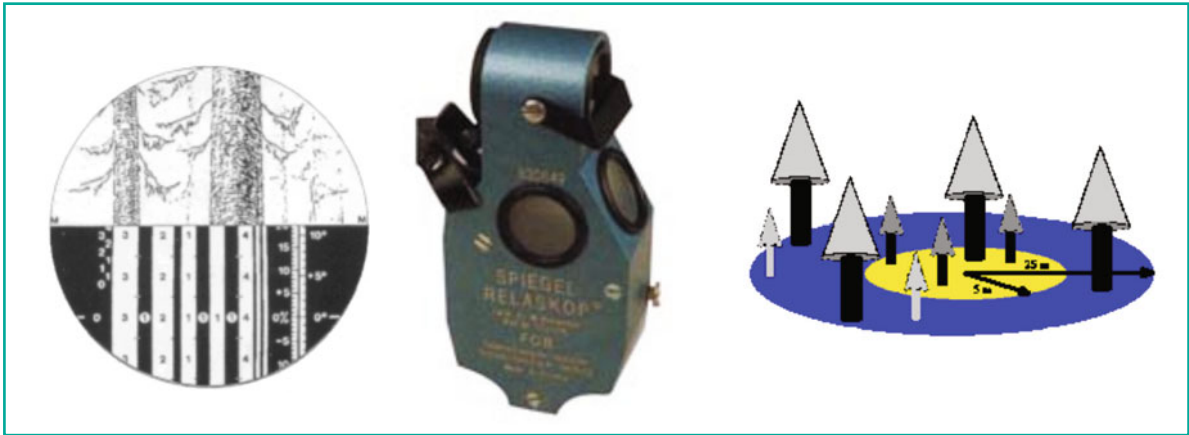
Fig. 5.5 Relascopio a specchio di Bitterlich, Università di Vienna. Al centro lo strumento, a sinistra i traguardi ottici, a destra un esempio di stazione di rilievo della fitomassa arborea dal punto di stazione dello strumento
