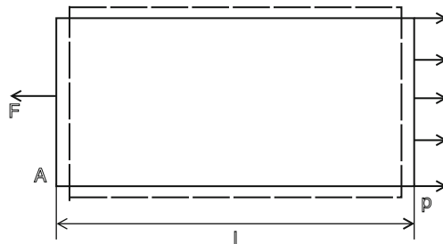
Fig. 1.11. Bar in tension
