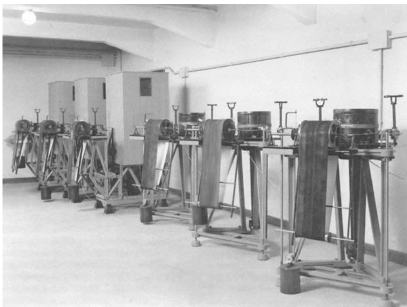
Sismografi di tipo Wiechert, con registrazione su rullo di carta affumicata, interamente costruiti nei laboratori ING fra il 1937 e il 1939, messi in fila nella "sala ricerche e collaudi" dell'Istituto, in attesa di essere trasferiti in varie stazioni periferiche (da Lo Surdo A. (1940) La registrazione, op. cit.)
