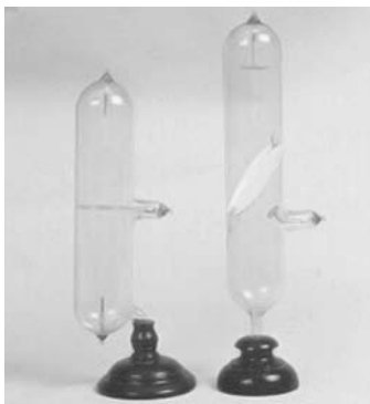
Tubi a scarica dei primi del Novecento. Riempiti con tracce di gas come l'idrogeno e l'elio, e attraversati da scariche elettriche ad alta tensione, emettevano bagliori la cui analisi per mezzo di spettroscopi permetteva di studiare il comportamento degli elettroni negli atomi (per cortesia del Museo di Fisica e del Sistema Museale dell'Università di Bologna)
