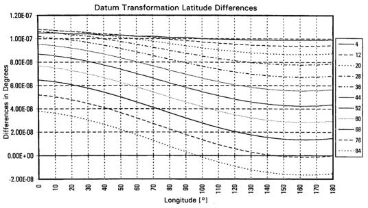
Figure 59: Datum transformation round-trip error of latitude
