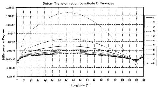
Figure 60: Datum transformation round-trip error of longitude
