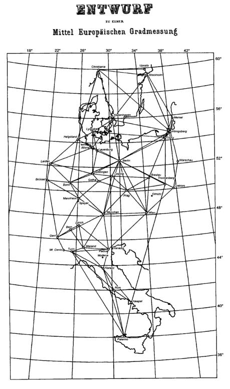
Figure 138: Baeyer's design of the Mittel-Europäischen Gradmessung
