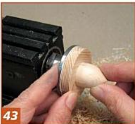
43 Press the nut onto the tenon.
