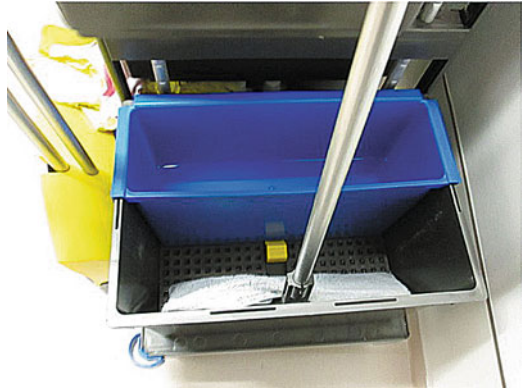
■ Abb. 5.15 Vorderer Eimer mit Dosierpedal, das mit dem Mopphalter (mit aufgespanntem Mopp) betätigt wird. Aus dem hinteren Eimer gelangt Reinigungs- oder Desinfektionslösung in den vorderen Eimer. Fehlerpotenzial: retrograde Kontamination, wenn der Mop auf dem Fußboden aufgespannt wurde. (System Nr. 1)
