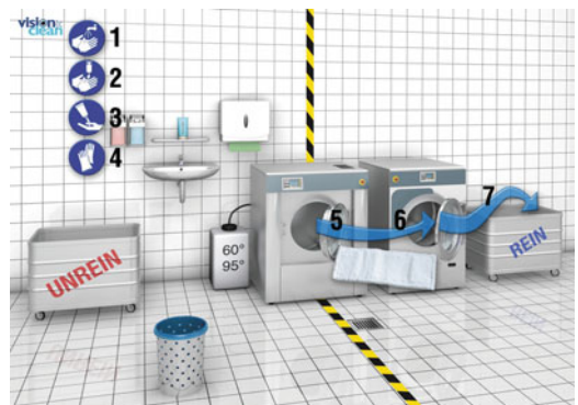
Abb. 5.22 Waschmaschine (unreine Seite) und Trockner (reine Seite) II: Wäschewechsel von der Waschmaschine zum Trockner (© Grafik: P. Henning/Fa. Visionclean, mit freundlicher Genehmigung)
