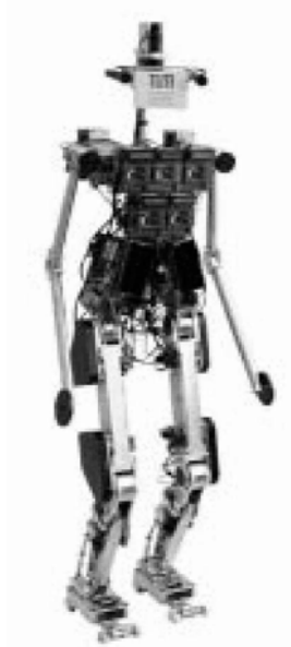
Figure 1.4. Robot “Johnnie” (courtesy H. Ulbrich, F. Pfeiffer, Lehrstuhl für Angewandte Mechanik, TU München), ©TU München
