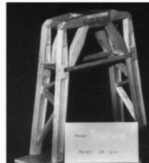
(d) Structure mass 48 gm failed at 492 N
