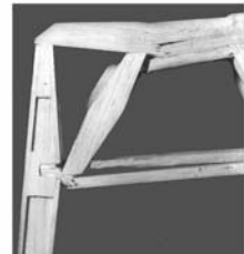
(d) Structure mass 48 gm failed at 492 N
