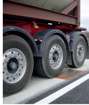
Fig. 15 Axle-load scale (Image by courtesy of Gassner Wiege- und Messtechnik, Salzburg, AT)
