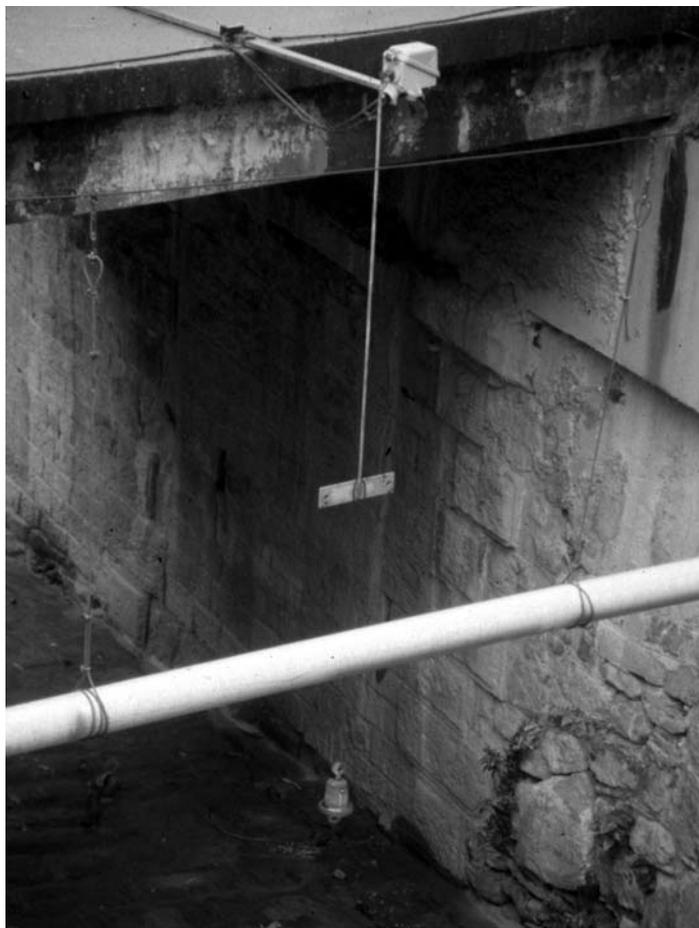
**Figure 18.45.** Contact warning by DLT (détecteur lave torrentielle) sensors at Ravoire de Pontamafrey, France.
