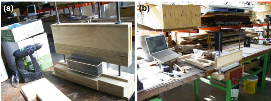
Fig. 13.52 a Mark-3 fin press. b Mark-4 fin press
