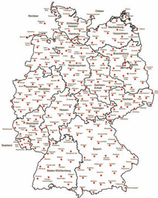
Fig. 7.19: Satellite Positioning Service (SAPOS) of the German State Survey Administration (status 2011), courtesy Landesbetrieb Geoinformation und Vermessung Hamburg ( http://www.hamburg.de/sapos ).
