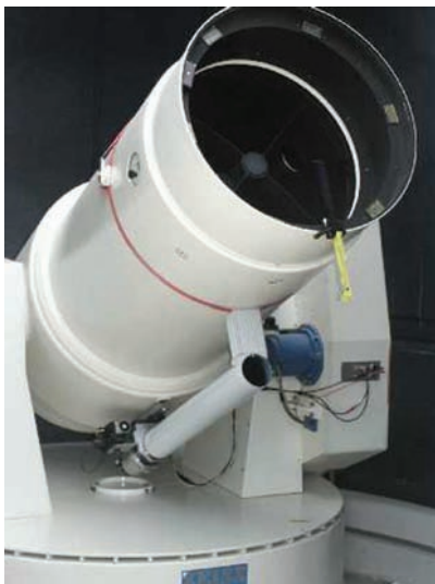
Fig. 5.26: 75 cm telescope, Wettzell Laser Ranging System (WLRs), Geodetic Observatory Wettzell, Germany, courtesy Bundesamt für Kartographie und Geodäsie (BKG), Frankfurt a.M., Germany ( http://www.fs.wettzell.de ).
