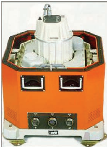
Fig. 5.67: Gravimeter System KSS31M with Gravity sensor Gss30 and gyro-stabilized platform KT 31, Bodenseewerk Geosystem, Überlingen, Germany, courtesy Bundesanstalt für Geowissenschaften und Rohstoffe (BGR).
