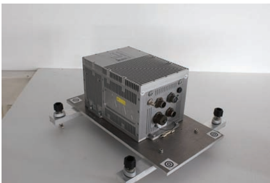
Fig. 5.85: iMAR iNAV-RQH: Inertial Laser Gyro Navigation System, courtesy M. Becker, Institut für Physikalische Geodäsie (IPG), TU Darmstadt.
