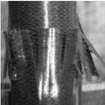
(d) Local buckling failure
