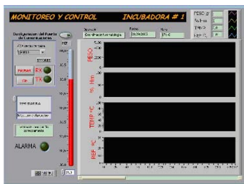
Fig. 2 Pantalla de seguimiento y control de la unidad neonatal
