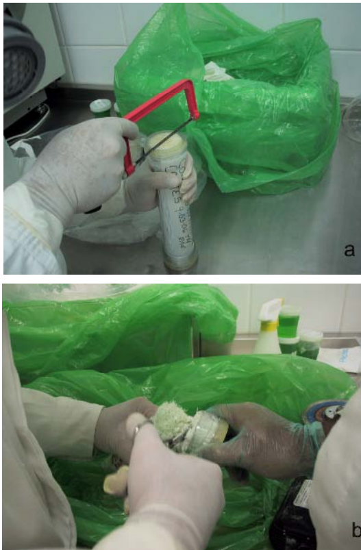
Fig. 1. Extracción de las muestras. a) Apertura del cartucho hemodialítico de polisulfona, b) corte de las fibras de membrana de polisulfona.
