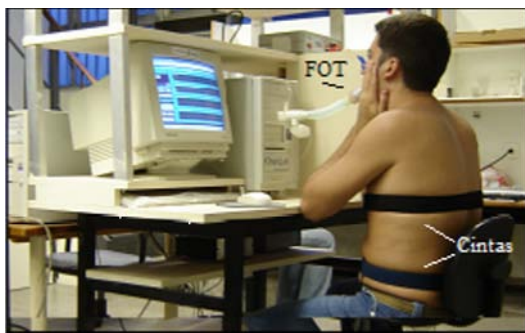
Fig. 1 Descrição dos ensaios referentes à avaliação simultânea de impedância e padrão respiratório.
