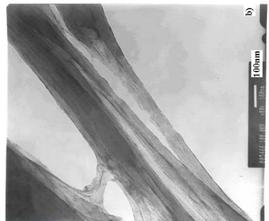
Fig. 3b) Micrografías de la mezcla PEAD/Colágeno
