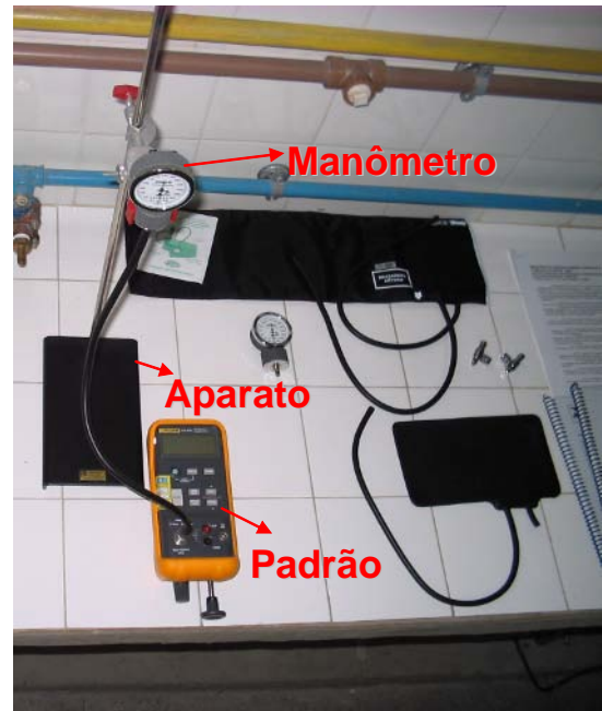
Fig. 1 Montagem experimental para a realização das medições de calibração dos esfigmomanômetros.
