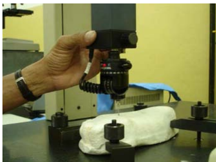
Fig. 1: Medição da superfície plantar do molde de gesso do pé de um sujeito do estudo.
