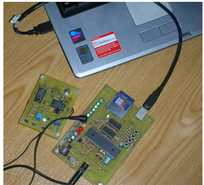
Fig. 4 Pruebas con el segundo prototipo y el simulador de ECG
