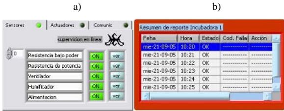
Fig. 1 a) Panel de Alarmas en Instrumentación creado con LabVIEW6i. b) Pantalla de reporte en una estación local (proceso)
