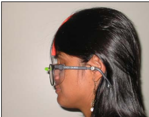
Figura 2 – Dispositivo com olivas inseridas no meato auditivo
