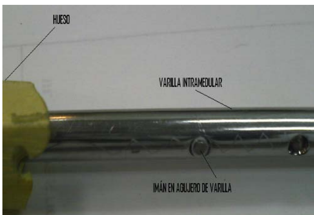
Fig. 1 Varilla intramedular sólida con “imán objetivo” incrustado en un agujero de bloqueo.
