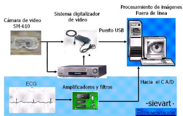
Figura 1 Se presenta el montaje del sistema para el registro simultáneo de variabilidad de frecuencia cardiaca y variabilidad de áreas pupilares en respiración controlada.
