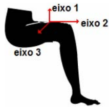
Fig. 1 Posicionamento do sensor de MMG no ventre muscular do RF
