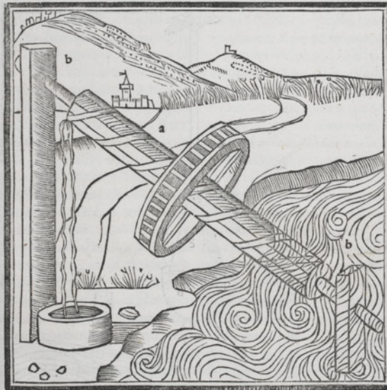
a. cocleæ ad rationem tri goni pytha gorici erectæ b. tigna in q̄ uerfatur co cleæ.
