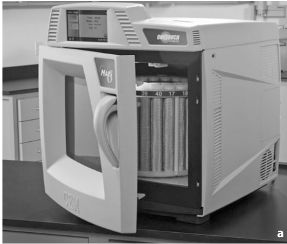
Fig. 4.3 Sistema commerciale a microonde diffuse MARS 6: a configurazione per PMAE; b configurazione per APMAE a singola postazione. (CEM Corporation. Riproduzione autorizzata)
