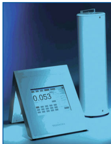
Fig. 8.23 Esempio di calibratore di dose con camera a ionizzazione. (Riprodotta dal sito web www.europrotex.com/pdf/calibratore.pdf , ultimo accesso in data 24.09.2009)
