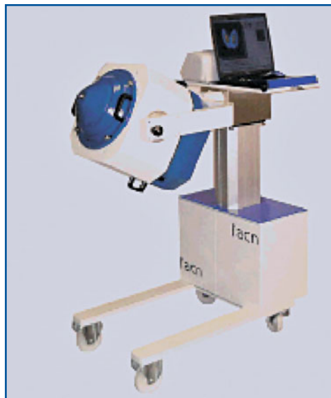
Fig. 8.19 Esempio di sonda per misure di captazione tiroidea di ultima generazione (il cui rivelatore è costituito da una gamma camera a piccolo campo. (Riprodotta dal sito web http://www.acn.it/www.iacn/MedNuc.3.htm , ultimo accesso in data 24.09.2009)
