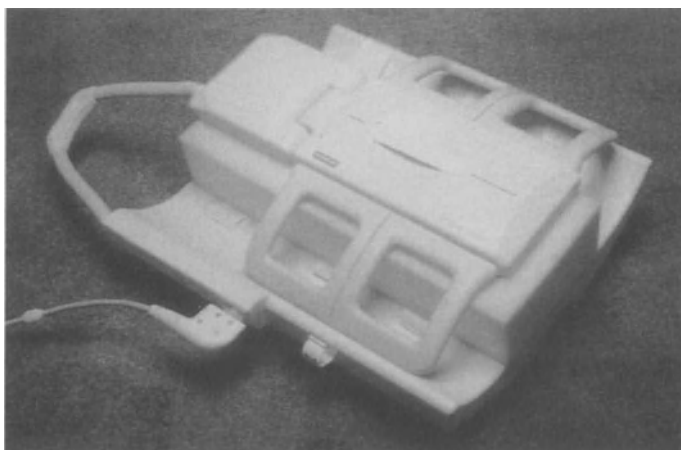
Abb. 1. Phased-Array-Körperspule zur Bildgebung des Thoraxraumes
