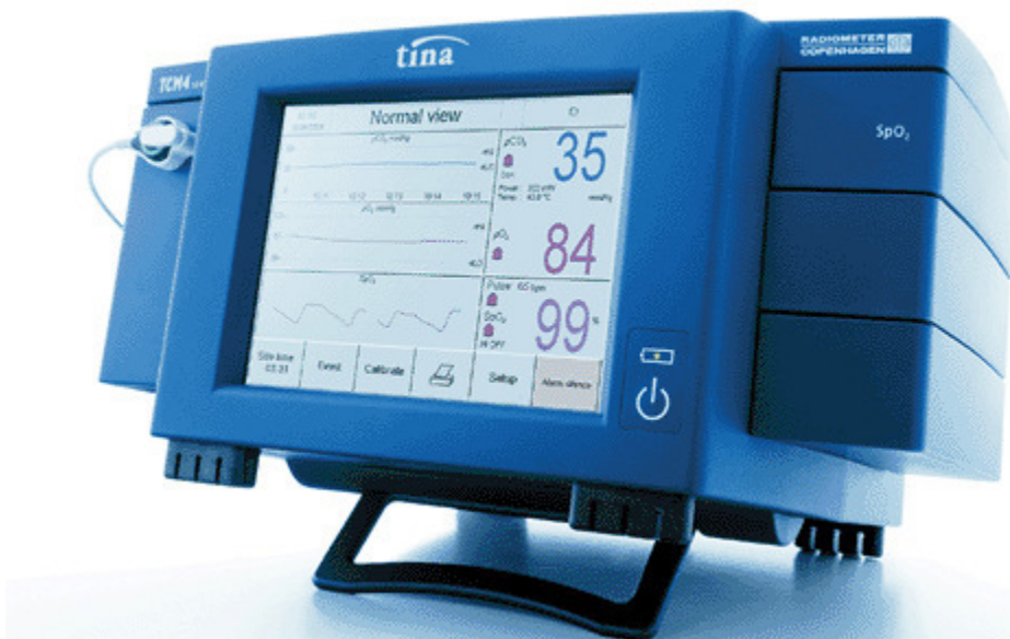
FIG. 9.9. Combined transcutaneous PO_2/PCO_2 and SpO_2 monitor. (Courtesy of Radiometer.)
