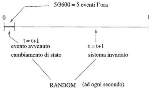
**Fig. 8.4.** Simulazione sincrona di un evento di probabilità pari a 5 eventi/ora
