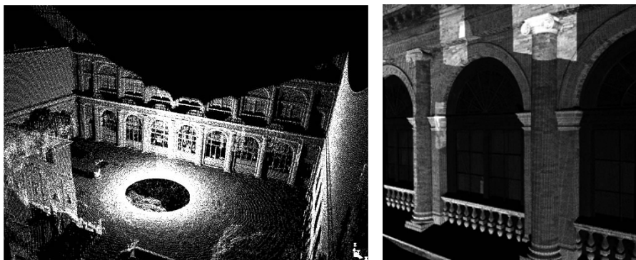
Figure 8-9 Points' clouds of the 'Chiostro della Carità'
