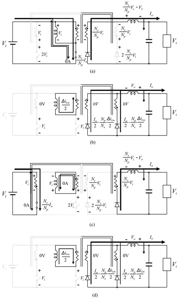
**Figure 3.16** Equivalent circuits for each operation state. (a)  $t_0 - t_1$ , (b)  $t_1 - t_2$ , (c)  $t_2 - t_3$ , and (d)  $t_3 - t_4$ .
