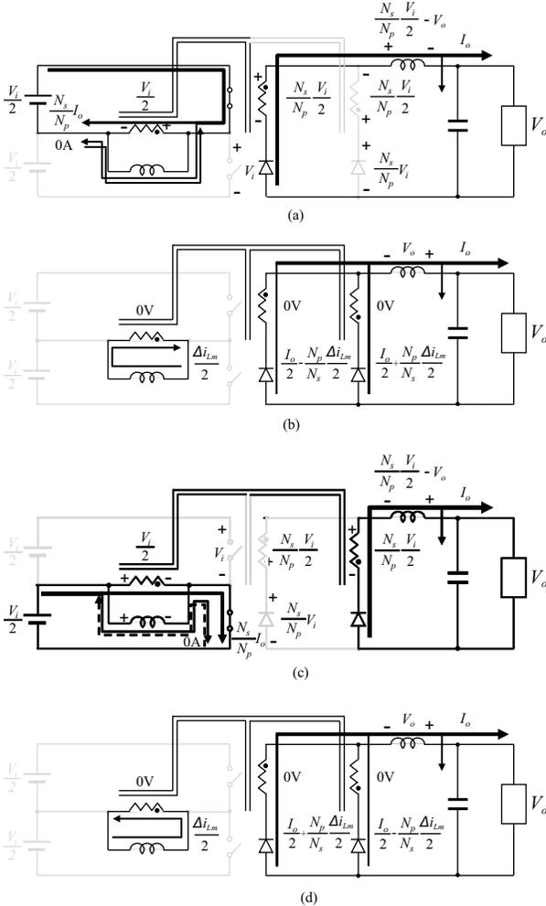
**Figure 3.20** Equivalent circuits for each operation state. (a)  $t_0 - t_1$ , (b)  $t_1 - t_2$ , (c)  $t_2 - t_3$ , and (d)  $t_3 - t_4$ .
