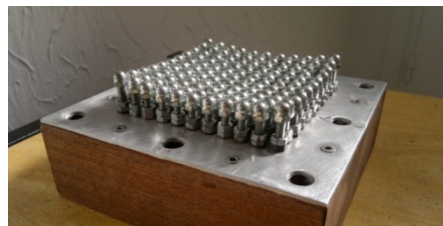
Fig. 4 Multipoint die set up for (MPFH)
