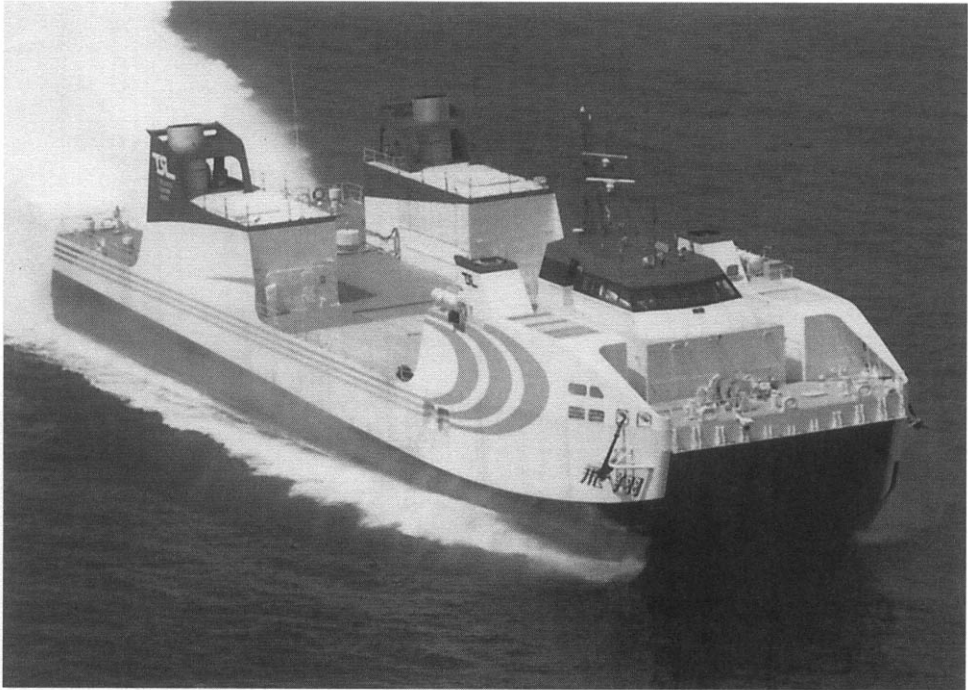
Fig. 16.16 TSL-A prototype SES Nissho.
