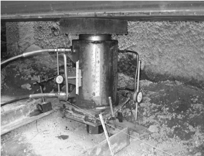
**FIG.4. Micropile compression test**
