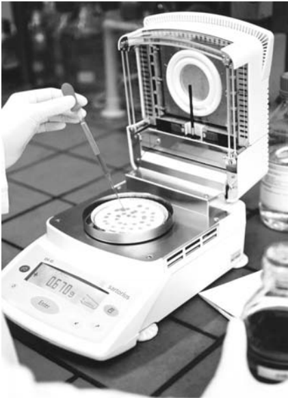
Fig. 2 Moisture analyser (photo: Sartorius)
