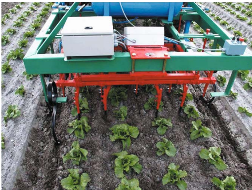
Fig. 11.2 The Radis blade arm hoe (Bleeker 2005)
