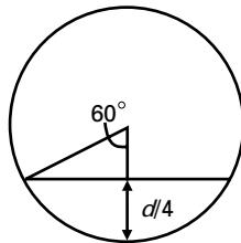
$$\text{Full : } 0.13 \text{ m}^3 \cdot \text{s}^{-1} = \frac{\pi}{4} d^2 (58 \text{ m}^{1/2} \cdot \text{s}^{-1}) \sqrt{\frac{d}{4} i} \quad (1)$$
