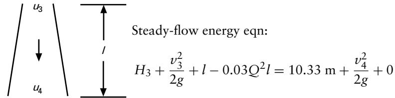
$$l(1 - 0.03Q^2) = (10.33 - 3.6) \text{ m} + \frac{1}{2g} (v_4^2 - v_3^2)$$
