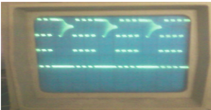
Fig. 105.11 Switching pulse and v ds
