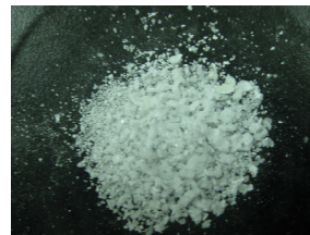
Fig4. The white precipitation- TiOSO_4 .
