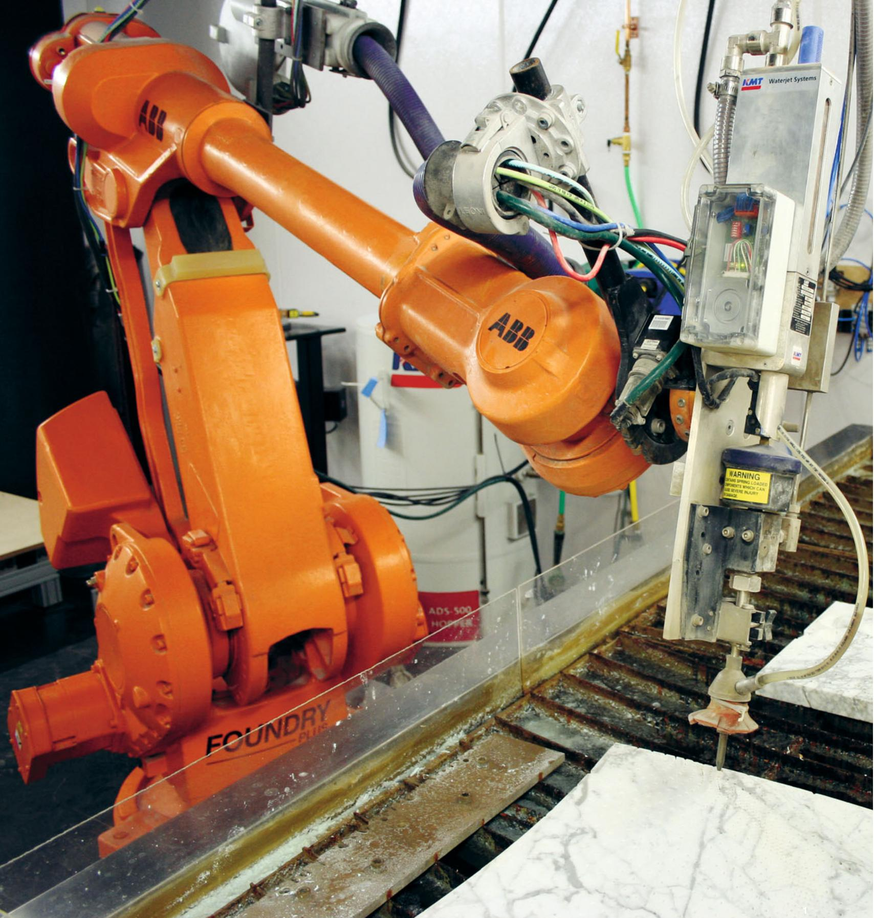
1 Cutting a test panel with the robotic water jet at the GSD's fabrication lab. Schneiden einer Testplatte mit dem Roboter-Wasserjet im GSD-Fertigungslabor.
