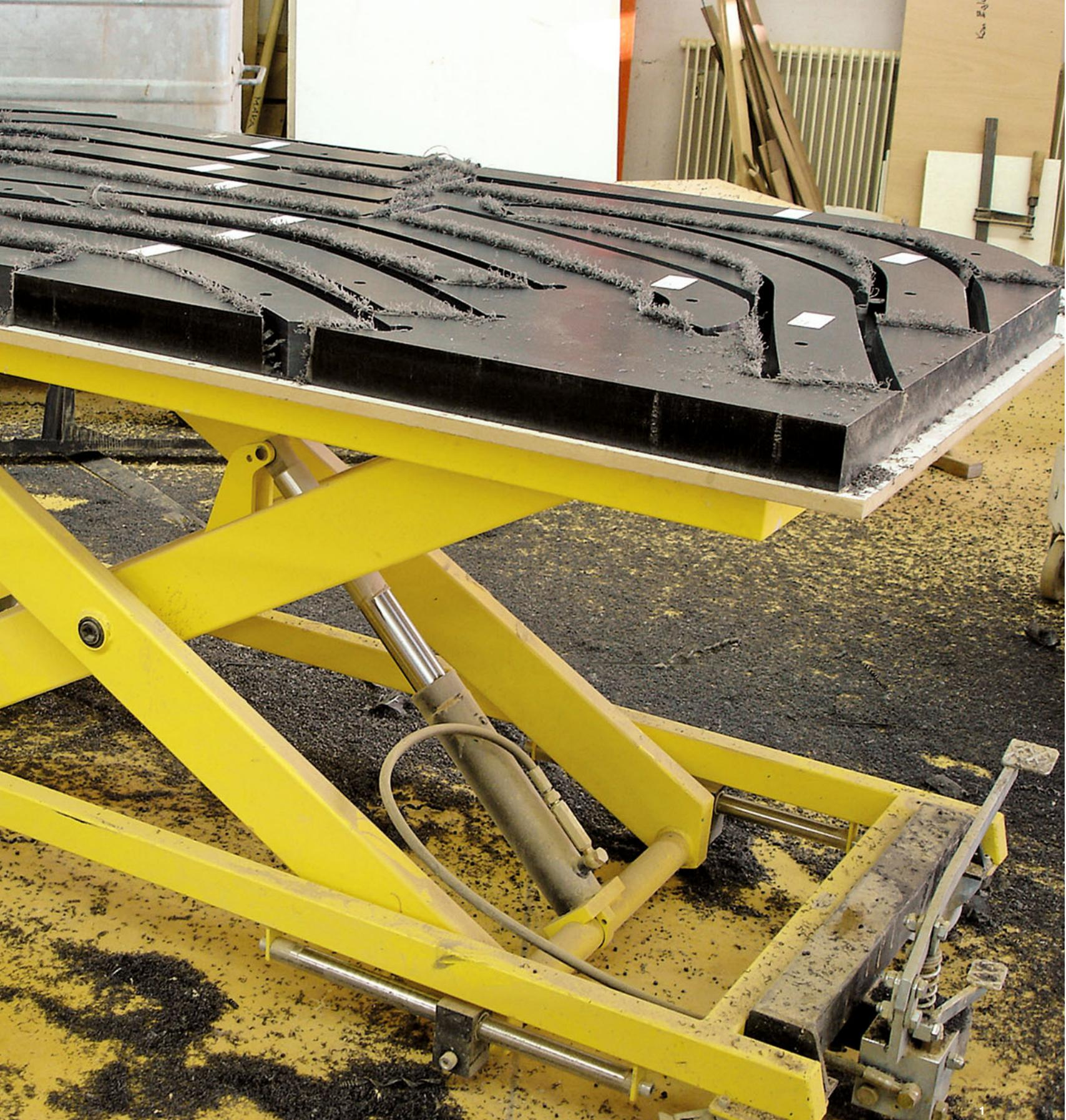
1 Standardisiertes Halbzeug als Ausschneidebogen in der Produktion individueller Bauteile für Zaha Hadid's Hungerburg-Bahn in Innsbruck, Foto: Fabian Scheurer, designtoproduction GmbH.
